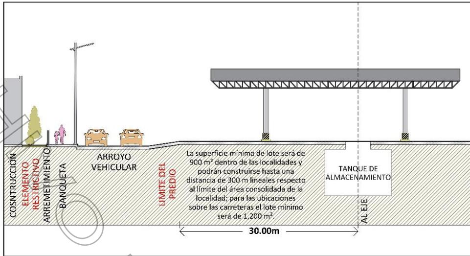
GASOLINERA A-1 (sección)
